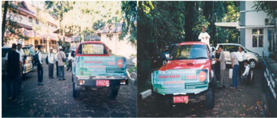
Gambar 5. Uji coba kedua Bogor-Cibinong menggunakan Jeep Daihatsu dan Daihatsu Strada berbahan baker biodiesel nyamplung 100% (B-100)
